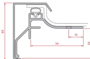
Profil de base (inférieur) : Pourvu d'une bande d'epdm et de trous percés en usine (à l'exception des angles sortants).
