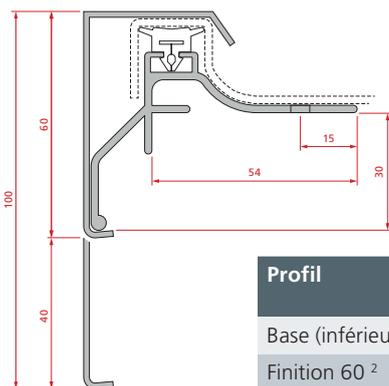
Pourvue d'une bande d'epdm et de trous percés en usine.
